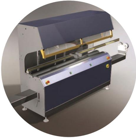
La Mx450TA è una macchina semiautomatica progettata per il taglio di **anime di cartone di grande spessore** ed è in grado lavorare con tubi da un diametro di 60 mm fino a 450 mm.
