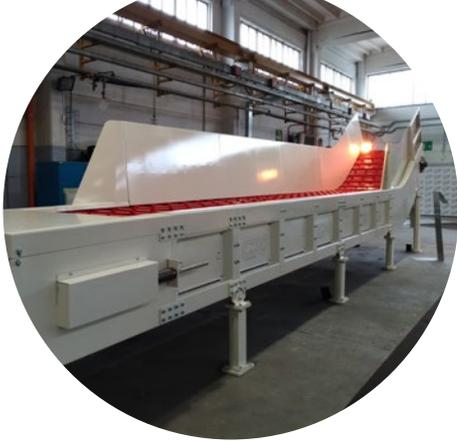
Le tapparelle ottenute da piegatura a freddo hanno larghezza 1250 o 1500 mm e spessore 5 mm, sono montate sulla **catena con bulloni e dadi autobloccanti**. Sulla superficie superiore sono montati dei perni metallici in modo da lasciare spazio tra tapparelle e balle per la **rimozione dei fili** dopo il taglio.
