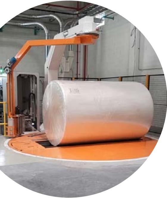
La embaladora We177R es un dispositivo diseñado para envolver bobinas en modo axial utilizando un brazo giratorio. La máquina está compuesta por un grupo de rodillos instalado sobre una plataforma giratoria, que **soporta la bobina** durante el ciclo de envoltura, y por una estructura que soporta el brazo giratorio.
