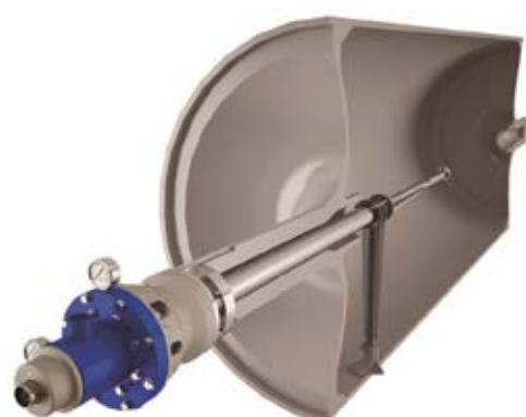
El cartucho de unión es intercambiable con el cartucho de vapor. El agua se inyecta en el cilindro por medio de boquillas de abanico montadas en el sifón fijo, lo que asegura la **uniformidad del fluido refrigerante**. Las JUNTAS ROTATIVAS DUOFLOW PARA ENFRIAMIENTO han sido diseñadas y realizadas con el objetivo específico de conjugar funcionamiento y bajos costos de mantenimiento.
