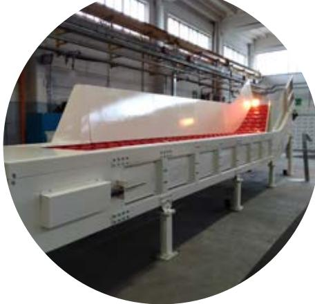
Las persianas metálicas de diseño Aerothermic, están fabricadas mediante plegado en frío, tienen un ancho de 1250 o 1500 mm y un espesor de 5 mm. Las persianas están montadas en la **cadena con pernos y contratuerca**s. En la superficie superior se montan pasadores metálicos para dejar espacio entre las persianas y las pacas para retirar los cables después del corte.
