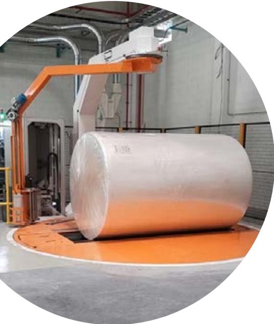
Il fasciatore We177R è un dispositivo progettato per fasciare bobine in modalità assiale utilizzando un braccio rotante. La macchina è composta da un gruppo rulli installato su una piattaforma rotante, che **sostiene la bobina** durante il ciclo, e da una struttura che sostiene il braccio rotante.
