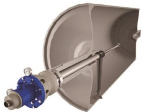
El cartucho de unión es intercambiable con el cartucho de vapor. El agua se inyecta en el cilindro por medio de boquillas de abanico montadas en el sifón fijo, lo que asegura la **uniformidad del fluido refrigerante**. Las JUNTAS ROTATIVAS DUOFLOW PARA ENFRIAMIENTO han sido diseñadas y realizadas con el objetivo específico de conjugar funcionamiento y bajos costos de mantenimiento.
