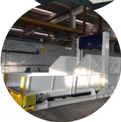
Cuando la bobina se coloca debajo del portal vertical, el Operador impulsa **la cuchilla que penetra** la bobina hasta llegar al núcleo interior del tubo de carton (core). La extracción del centro debe ser realizada manualmente por el Operador. Al terminar, el Operador puede continuar el descenso de la cuchilla para cortar completamente la pila de hojas resultante. Esto se puede repetir operando la cinta transportadora para dividir las hojas del paquete en trozos más pequeños.
