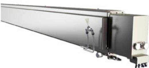
Sistema diseñado por Fomat para la distribución uniforme de productos químicos sobre cilindros y lonas del lado seco. El sistema incluye una boquilla atomizadora de fabricación propia para reducir el consumo de productos químicos y un HMI (panel táctil remoto) que permite configurar su velocidad de acuerdo con la velocidad de la máquina. La unidad de control puede integrarse a todos los tipos de DCS o interconectarse directamente con el sistema de dosificación de Fomat
