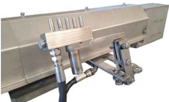
Diseñado para mejorar aún más las operaciones de limpieza de malla, el sistema Smart Jet reduce el consumo de agua y permite intervenir directamente en la zona sucia gracias a un cabezal giratorio especial con 5 boquillas que proporciona una mayor acción de limpieza. El diseño del sistema incluye un área de estacionamiento/ almacenamiento para mantenimiento, mientras la máquina está funcionando.
