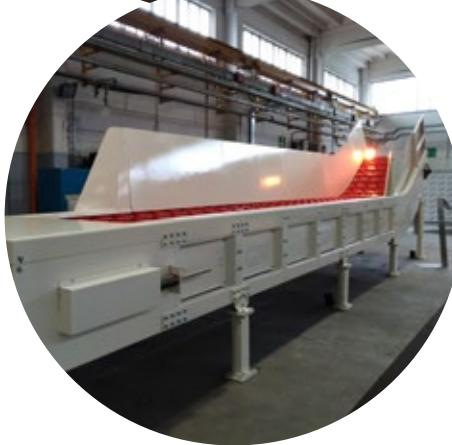
Le tapparelle ottenute da piegatura a freddo hanno larghezza 1250 o 1500 mm e spessore 5 mm, sono montate sulla **catena con bulloni e dadi autobloccanti**. Sulla superficie superiore sono montati dei perni metallici in modo da lasciare spazio tra tapparelle e balle per la **rimozione dei fili** dopo il taglio.
