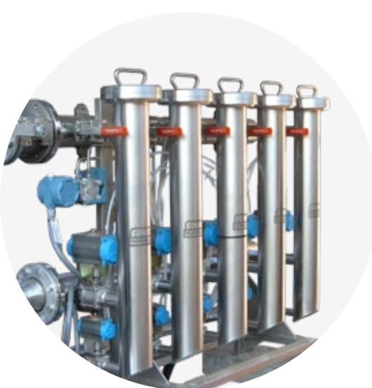
Questo filtro consente un grado di filtrazione fino a **80 micron** ed è dotato di un sistema di pulizia automatico in controlavaggio. È indicato per l'utilizzo di acqua fresca in **totale sicurezza** soprattutto quando prelevata da pozzo.
