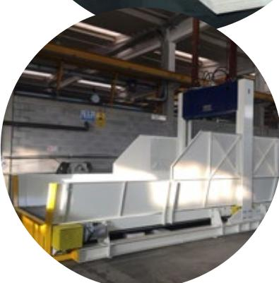
Quando la bobina arriva nella posizione corretta, l'Operatore da inizio alla fase di taglio, **la lama penetra** nella bobina fino a raggiungere l'anima interna di cartone. La rimozione dell'anima deve essere effettuata manualmente dall'Operatore. Al termine, l'Operatore può continuare l'operazione di taglio e se necessario ripetere il ciclo per ridurre la carta in parti più piccole.
