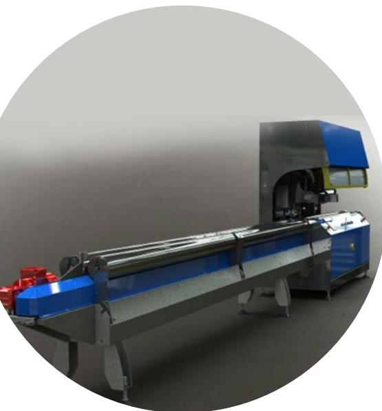
La Mx450STA è una macchina automatica progettata per il taglio di anime di cartone di grande spessore ed è in grado lavorare con tubi da un diametro di 70 mm fino a 400 mm. L'ampio range di lavoro della macchina è ottenuto mantenendo la lama sempre nella stessa posizione e facendo ruotare l'anima su appositi rulli.
